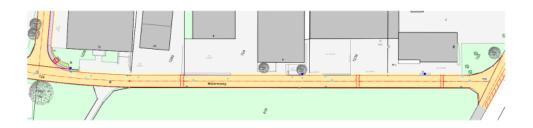
Der Wislerenweg wird mit einem Deckbelag versehen. Die Strasse ist bereits saniert und die Randabschlüsse gebaut.
